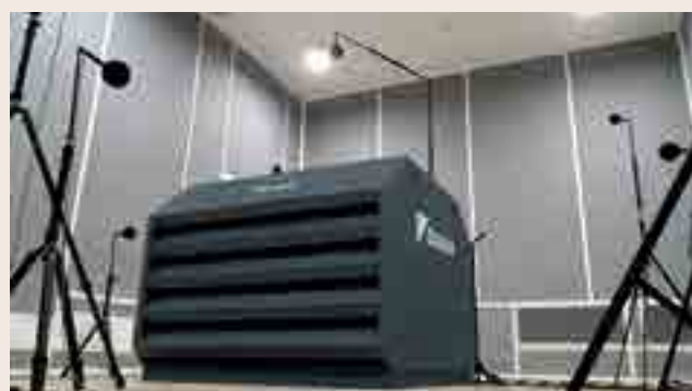
Pomiar poziomu mocy akustycznej w komorze akustycznej
